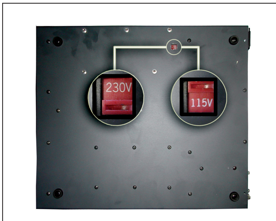
Figura 5.1: interruttore cambia tensione sulla parte sottostante URPT/MIC
