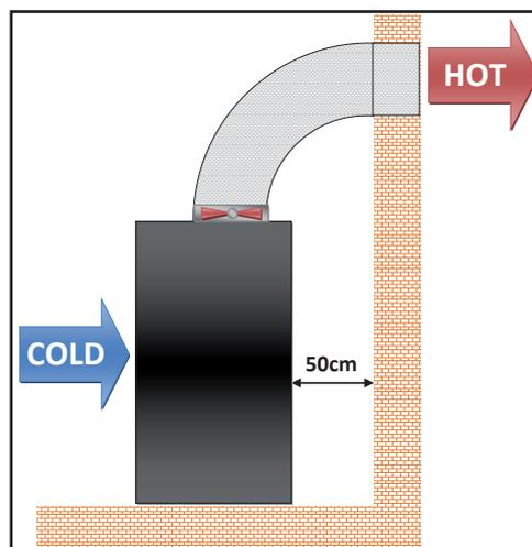
Si consiglia vivamente di installare il rack almeno 50 cm dalla parete posteriore e laterale in modo da consentire un flusso d'aria ottimale e facilitare i lavori di manutenzione.
