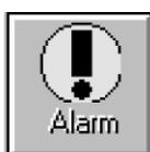
Il tasto “Alarm” apre la finestra dello storico degli allarmi verificati (valido solo per macchine SCM e TLC).
