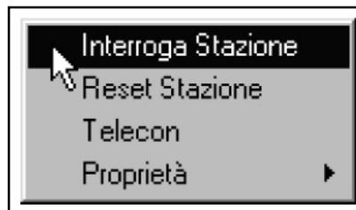
Scegliendo “Reset Stazione” si tenta di ripristinare le condizioni di funzionamento in caso di allarme.
