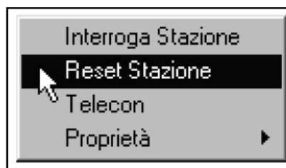
Scegliendo “Telecon” si esegue la chiamata alla stazione utilizzando il normale software di telemetria in modo da poter avere informazioni più dettagliate (per utenti più esperti).
