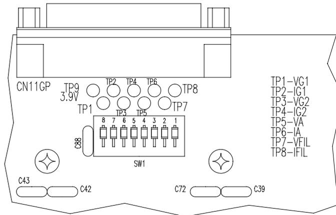
A causa dei vari tipi di valvole su cui vengono applicate queste schede si può verificare che, le tensioni che si sono misurate, possono essere sia positive che negative; ma all'uscita dei Test Point si ha bisogno sempre di una tensione positiva. Per ottenere questo bisogna intervenire spostando dei jumper sulla scheda a coppie di due alla volta in base alla misura che risulta negativa.
