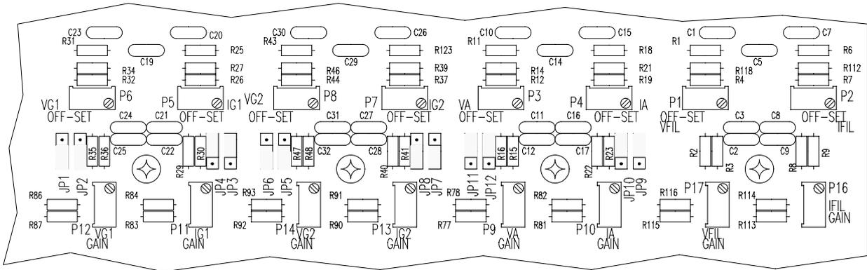
Terminate le operazioni precedenti si deve collegare un alimentatore con un amperometro in serie (vedi FIG. 28) per calibrare la massima corrente IA e IG1 (IG2 non presente su questa macchina, se la scheda fosse montata su un tetrodo bisogna considerare anche la IG2). Una volta calibrate le tensioni in uscita sui Test Point mediante i trimmer posti sulla scheda multimitro, controllare che lo strumento, posto sul pannello a cerniera segni correttamente.
