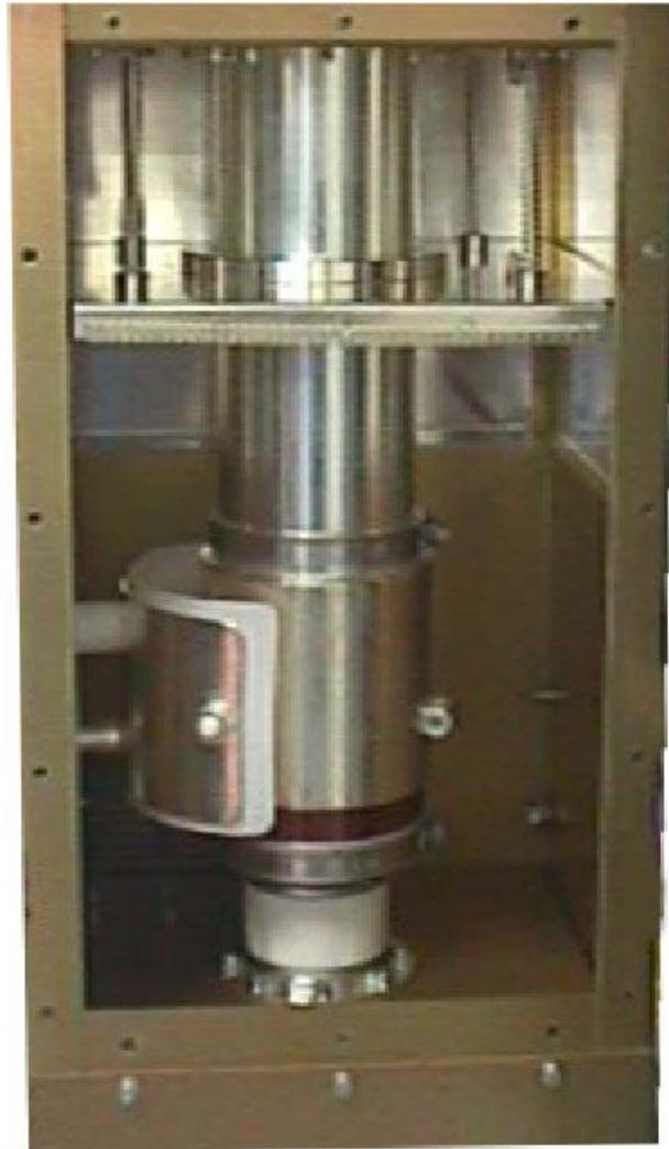
Movimentando il piano di sintonia tramite i pulsanti posti sul pannello frontale è possibile sintonizzare precedentemente all'aggiustamento fine dei valori di output la macchina. Fare riferimento ai valori sotto indicati per stabilire quale debba essere la distanza da applicare tra il piano scorrevole presente nella camera R.F. e il top di chiusura della cavità.
