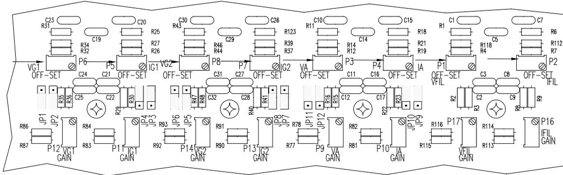
Per vedere i valori di tensione usare sempre il multimetro con il puntale negativo verso massa e il positivo sul Test Point corrispondente al valore che si vuole calibrare.
