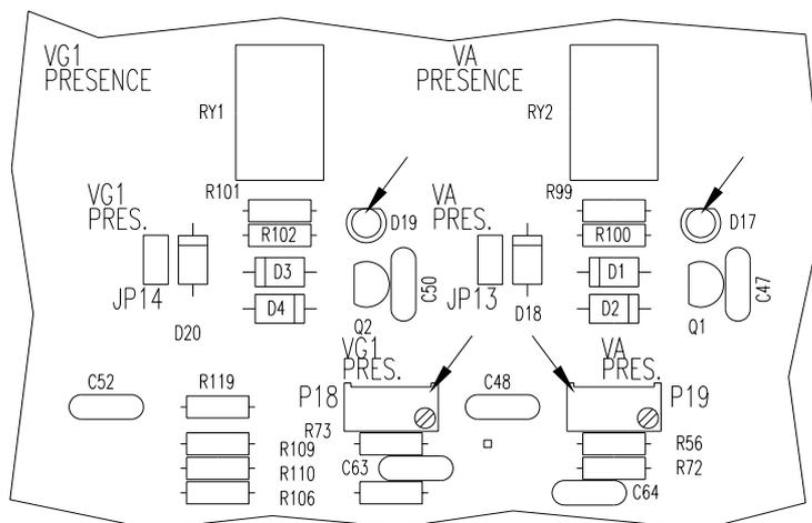
Nel caso che sulla macchina vi sia una valvola Triodo il controllo della VG1 viene escluso in quanto questa tensione si crea in automatico quando la valvola è in potenza e viene fatto inserendo il Jumper JP14, in modo che la sequenza di partenza sia ok, altrimenti la macchina non andrebbe mai in alta tensione.
