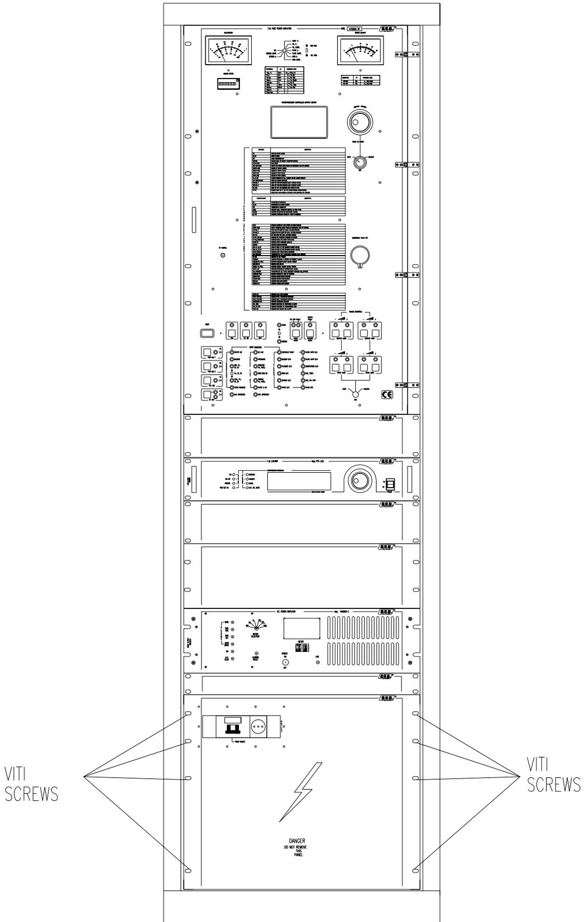
**FIG. 27 -DIAGRAMMA N°2 SOSTITUZIONE DELLA SCHEDA MISURE**
