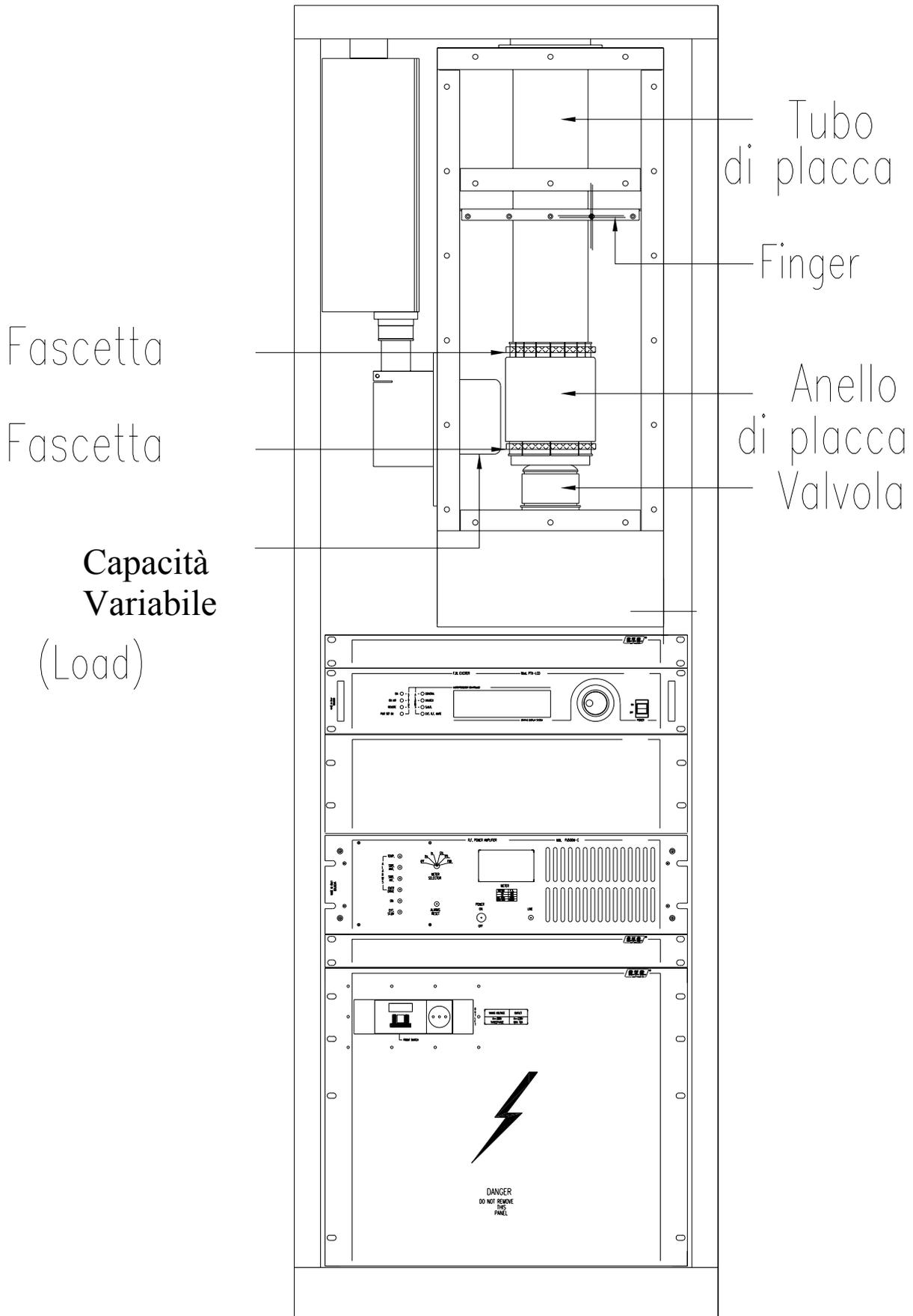
**FIG. 23 -VISTA DI RIFERIMENTO INSTALLAZIONE VALVOLA N°4**
