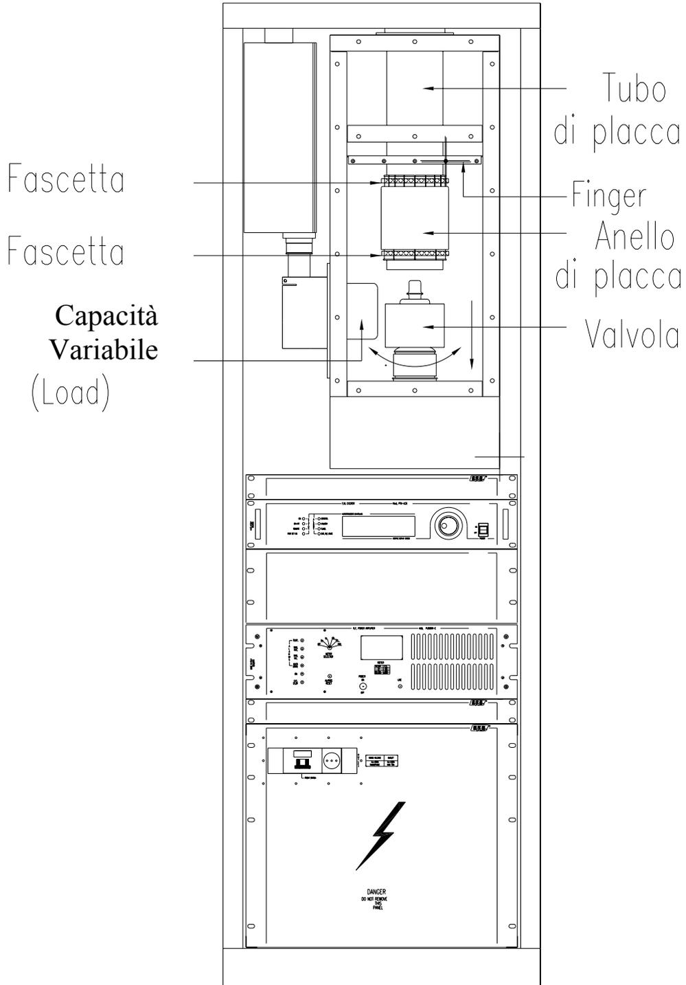
**FIG. 19 -VISTA DI RIFERIMENTO INSTALLAZIONE VALVOLA N°2**
