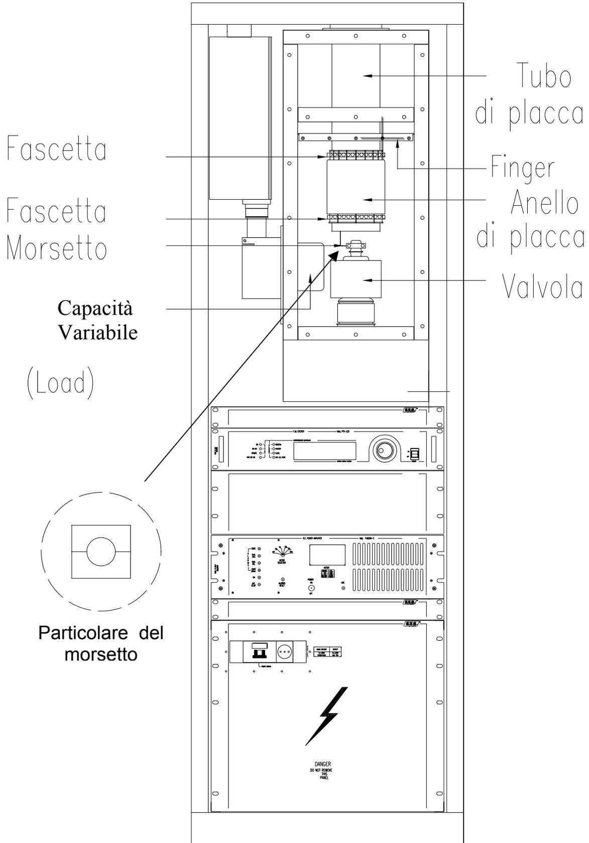
**FIG. 21 -VISTA DI RIFERIMENTO INSTALLAZIONE VALVOLA N°3**
