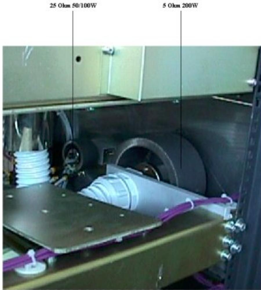
**FIG. 39 - INTERRUTTORE AUTOMATICO PER PJ1000 - FUSIBILI DI PROTEZIONE**
