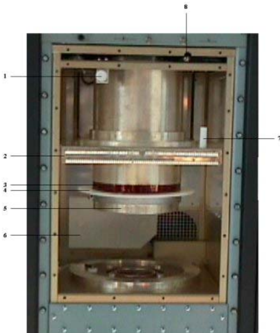
FIG. 6 - DESCRIZIONE VISTA FRONTALE CAMERA R.F.
