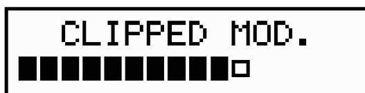
In questo menù vengono rappresentati, tramite barra orizzontale, i livelli di modulazione con l'utilizzo del limitatore di livello del segnale modulante.
